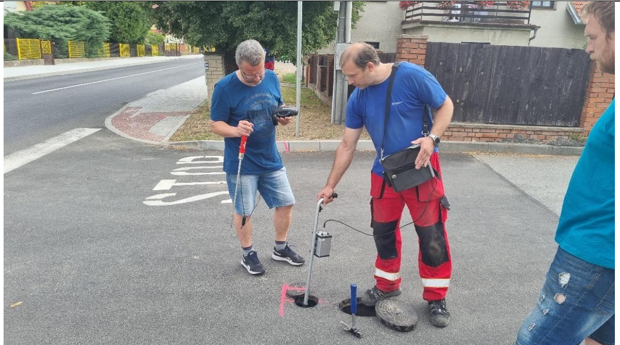
Foto /1/ Hledání úniků vody (snímek pořízen 28. 7. 2021).
